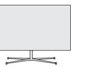
TITANO PERMETTE L'INSTALLAZIONE DI MONITOR DAI 55" AGLI 85". I CAVI SONO COMPLETAMENTE OCCULTATI ALL'INTERNO DELLA COLONNA LIBERAMENTE ORIENTABILE A 360°. UNA COPPIA DI CARTER POSTERIORI NASCONDE E DÀ ACCESSO RAPIDO ALLE PRESE DELLA TV. È ACCESSORIABILE CON UN SUPPORTO PER SOUND-BAR O LETTORI MULTIMEDIALI CHE INTEGRA E CELA COMPLETAMENTE I CAVI.
